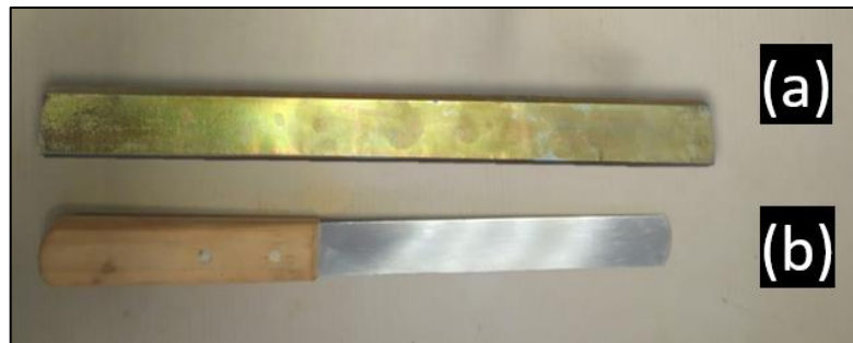
Figura 15 – Régua de aço biselada (a) e espátula com lâmina flexível (b)
