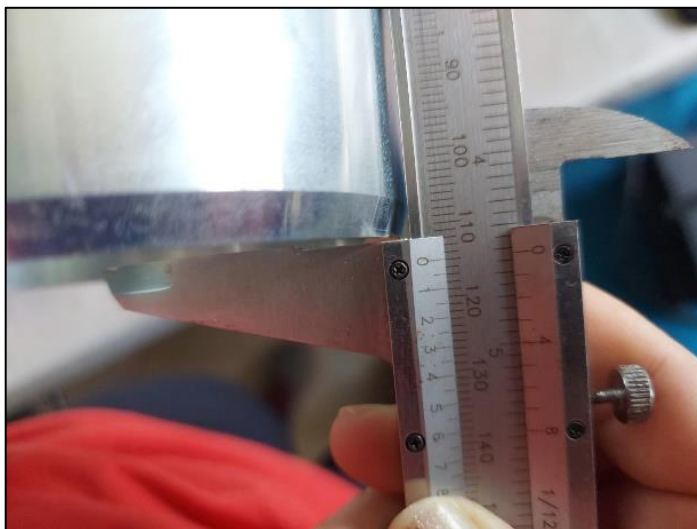
Figura 17 – Medição da altura do cilindro de cravação
