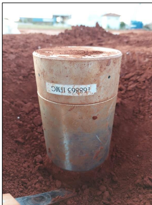
Figura 20 – Cilindro de cravação escavado
