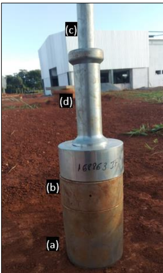
Figura 12 – Conjunto de cravação
