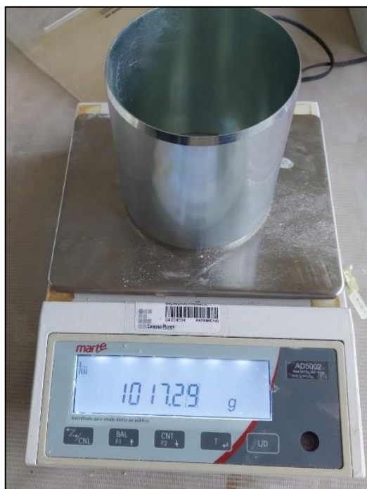
Figura 18 – Massa do cilindro de cravação
