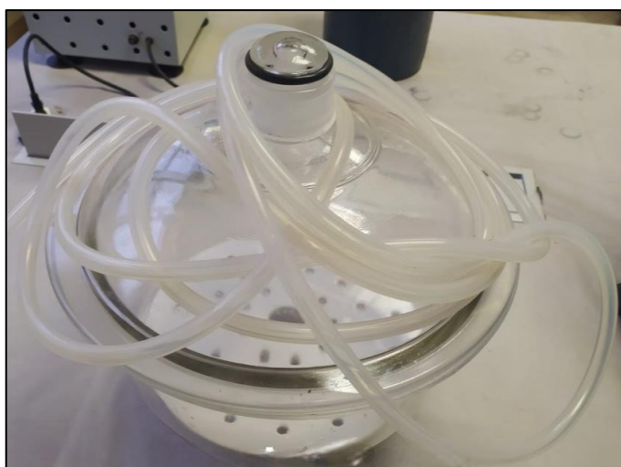
Figura 22 – Dessecador com sílica gel
