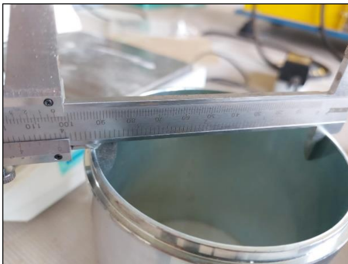
Figura 16 – Diâmetro interno do cilindro de cravação
