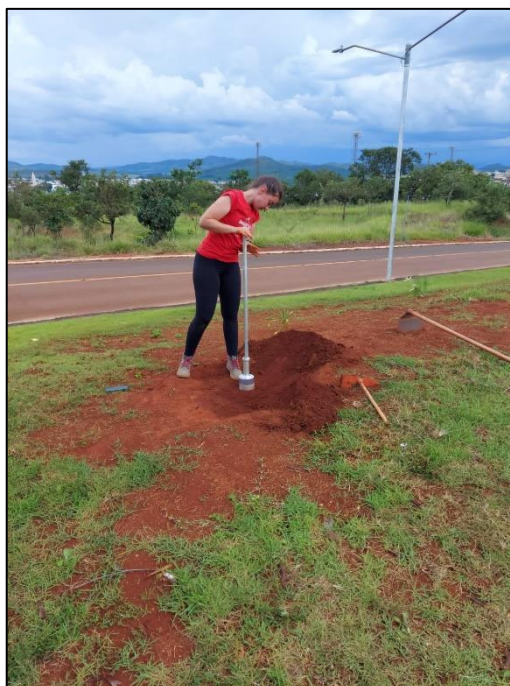
Figura 10 – Posicionamento e cravação do cilindro por queda livre
