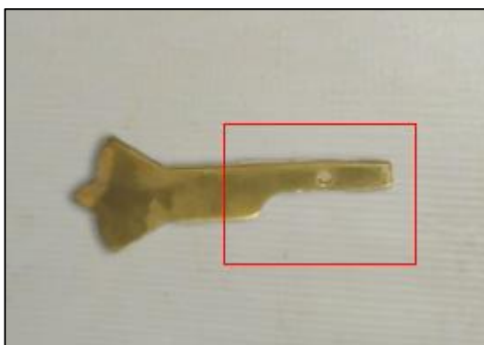
Figura 26 – Cinzel, no destaque gabarito de calibração
