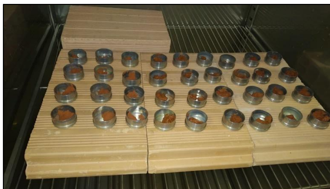
Figura 21 – Estufa de secagem com amostras de solo
