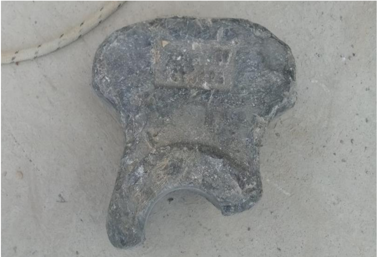
Figura 11: Falha em Martelo – Shredder (120 horas de Trabalho)
