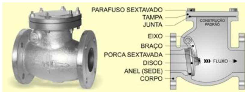
Figura 8 – Válvula de retenção
