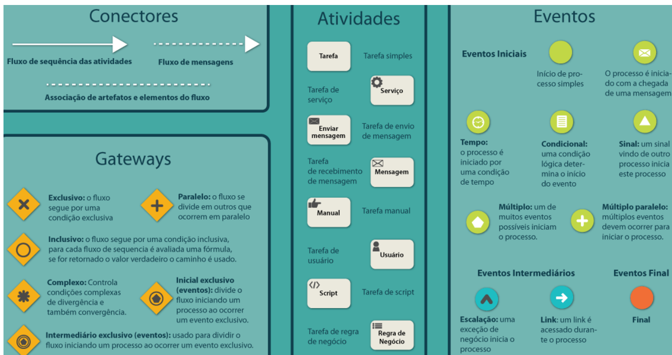
Figura 2: Símbolos utilizados no Modelo e Notação de Processos de Negócio (BPMN - Business Process Model and Notation)
