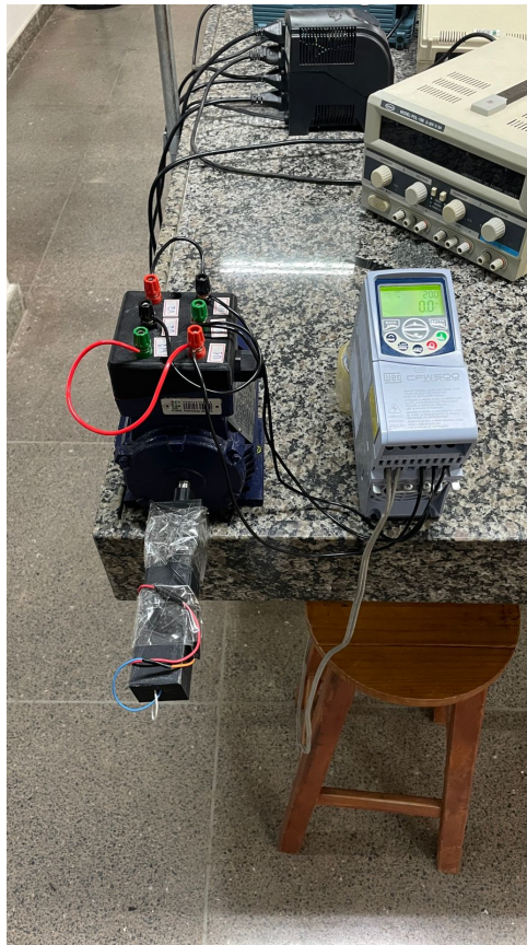
Figura 11 – Sistema montado para o teste de conectividade, incluindo motor trifásico, inversor de frequência, adaptador e caixa 3D com sensor ESP32.
