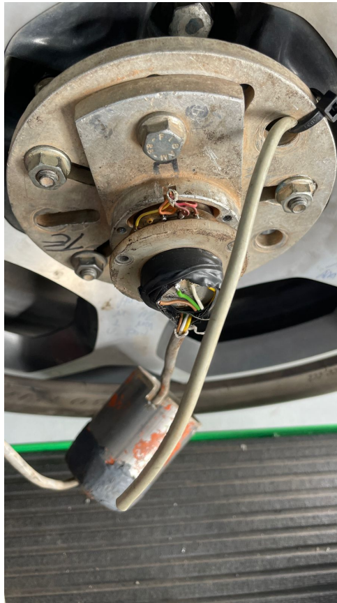
Figura 13 – Slip ring instalado na roda do veículo, responsável por transmitir o sinal do strain gauge rotativo para o sistema com fio.
