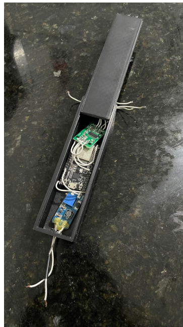
Figura 10 – Caixa protetora impressa em 3D para acomodação dos componentes eletrônicos do sistema. Foto de autoria própria.
